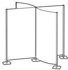
I pannelli divisori flessibili sono in grado di realizzare pareti continue sia curve che rettilinee. I montanti in alluminio estruso anodizzato naturale possono ospitare fino a 4 pannelli disposti tra loro a 90°. La base dei montanti è in acciaio verniciato "Silver". Il sistema di aggancio rapido brevettato di Quinta assicura operazioni di assemblaggio estremamente semplici e veloci.
