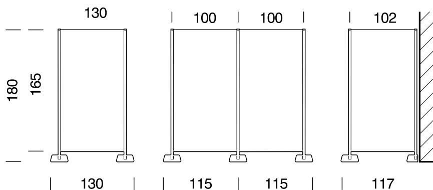
Mit den flexiblen Paneelen lassen sich sowohl gekrümmte als auch gerade Trennwände bilden. Die Aluminium-Ständer aus extrudiertem, eloxiertem Aluminium nehmen bis zu vier im rechten Winkel zueinander angeordnete Elemente auf. Die Stahlfüße der Ständer sind in der Farbe „Silver“ lackiert. Das patentierte Befestigungssystem von Quinta garantiert ein extrem einfaches und schnelles Zusammenbauen.
